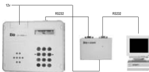
Il est impératif de mettre la centrale ELA+ en mode CONTINUOUS et de programmer l'heure d'import/export automatique (voir manuel du soft). ELA+COM s'utilise avec le logiciel PC (voir manuel de l'utilisateur, point 10).
